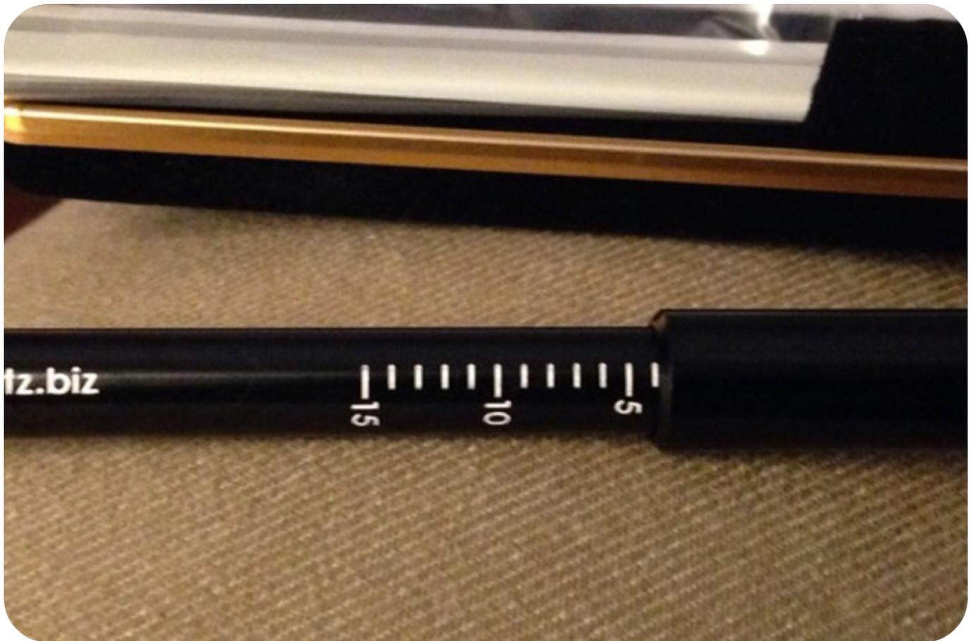
2.1.2. Dermografómetro calibrado. El dispositivo puede calibrarse a distintas presiones, desde la escala 0 (20 g/mm<sup>2</sup>) hasta la 10 (100 g/mm<sup>2</sup>).
